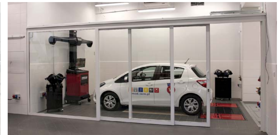
STANOWISKO PRZYJĘCIA POJAZDU DO SERWISU WYPOSAŻONE JEST W NOWOCZESNY SPRZĘT DIAGNOSTYCZNY HUNTER QUICK CHECK 3D I HUNTER QUICK TREAD
