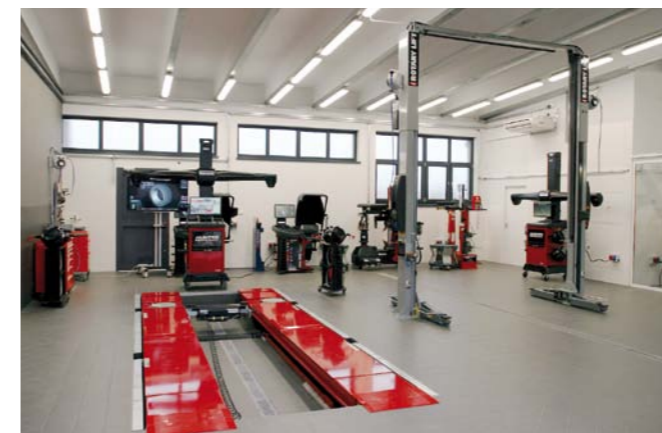
POMIAR I REGULACJA GEOMETRII USTAWIENIA KÓŁ I OSI POJAZDÓW ODBYWA SIĘ NA JEDNOSEKCYJNYM ZAGŁĘBIANYM DŹWIGNIKU NOŻYCYWYM ZA POMOCĄ URZĄDZENIA HUNTER 3D ELITE
