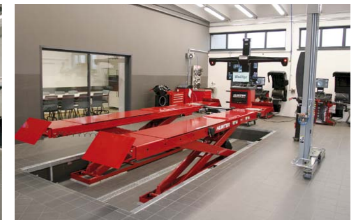
POMIAR I REGULACJA GEOMETRII USTAWIENIA KÓŁ I OSI POJAZDÓW ODBYWA SIĘ NA JEDNOSEKCYJNYM ZAGŁĘBIANYM DŹWIGNIKU NOŻYCYWYM ZA POMOCĄ URZĄDZENIA HUNTER 3D ELITE
