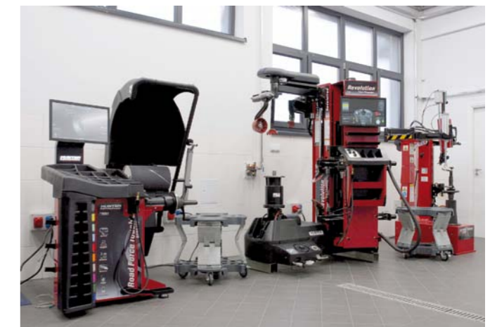
STANOWISKO DO OBSŁUGI KÓŁ WYPOSAŻONE JEST MIĘDZY INNYMI W WYWAŻARKĘ Z TESTEM DROGOWYM HUNTER RFE 20E ORAZ AUTOMATYCZNĄ I AUTONOMICZNĄ MONTAŻOWNICĘ HUNTER TCR1XE-435
