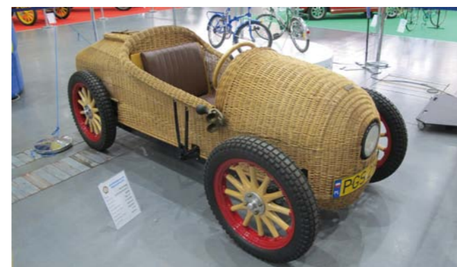
HANOMAG KOMMISSBROT KORBWAGE TO PRAWDZIWIE „LUDOWY” POJAZD O NADWOZIU WYKONANYM Z... WIKLINY
