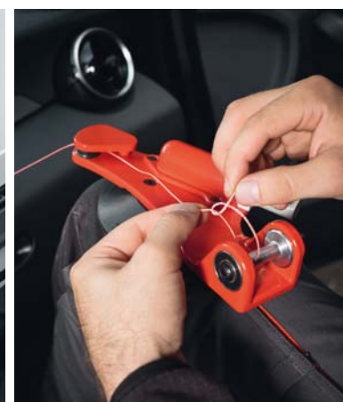
WYCINANIE SZYBY PRZY UŻYCIU MINIZESTAWU (Z LEWEJ) I MOCOWANIE SZNURA TNAJĘCEGO DO NARZĘDZIA SŁUŻĄCEGO DO WYCINANIA (ART. NR 0714 58 230)
