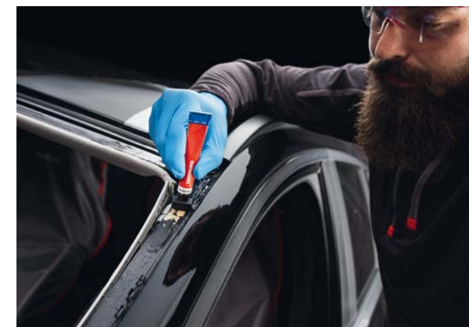
NAKLADANIE PODKŁADU 4W1 NA SZYBĘ ORAZ POWIERZCHNIĘ DOCIĘTEGO KLEJU NA KAROSERII (ART. NR 0890024010)
