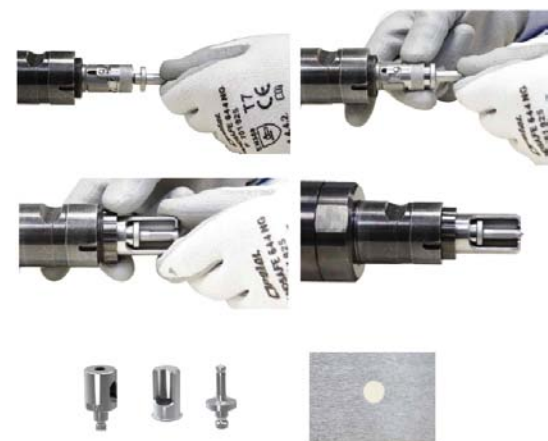
FOT. 6. MONTAŻ OPRZYRZĄDOWANIA DO WYKONANIA NITOWANIA (GYS-HERKULES). DZIURKOWANIE JEST WYMAGANE DLA ZACHOWANIA ODPOWIEDNIEJ ŚREDNICY OTWORU W STOSUNKU DO NITÓW NAPRAWCZYCH, CO POZWALA NA UZYSKANIE DOBREGO POŁĄCZENIA
