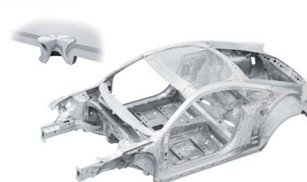
FOT. 4. NITOWANIE ORAZ KLINCZOWANIE (AUDI)
