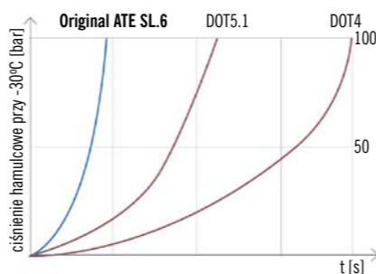
FOT. 3. CZAS REAKCJI UKŁADU ESP PRZY ZASTOSOWANIU POSZCZEGÓLNYCH PŁYNÓW HAMULCOWYCH
