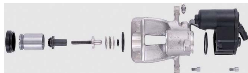
FOT. 12. BUDOWA ELEMENTU WYKONAWCZEGO ELEKTRYCZNEGO HAMULCA POMOCNICZEGO MARKI TRW
