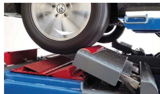
FOT. 9. SPRAWDZANIE MOMENTU HAMOWANIA PODCZAS BADANIA TECHNICZNEGO SAMOCHODU WYPOSAŻONEGO W EPB
