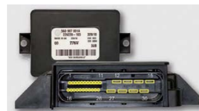
FOT. 11. POŁOŻENIE PINÓW W STEROWNIKU EPB
