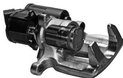
FOT. 1. HAMULEC TRW – ZACISK ZINTEGROWANY Z SILNICZKIEM ELEKTRYCZNYM
