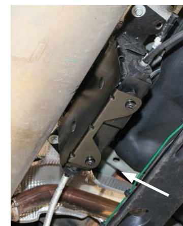
FOT. 6. SIŁOWNIK SYSTEMU ATE (CABLE PULLER) ZAMONTOWANY PRZY TYLNEJ BELCE RENAULT LAGUNA III
