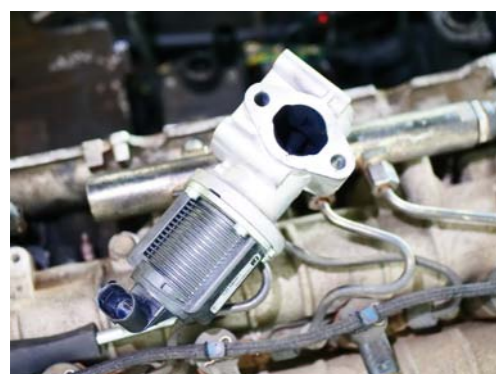
ZANIECZYSZCZONE NAGAREM ELEMENTY UKŁADU DOLOTOWEGO SILNIKA
