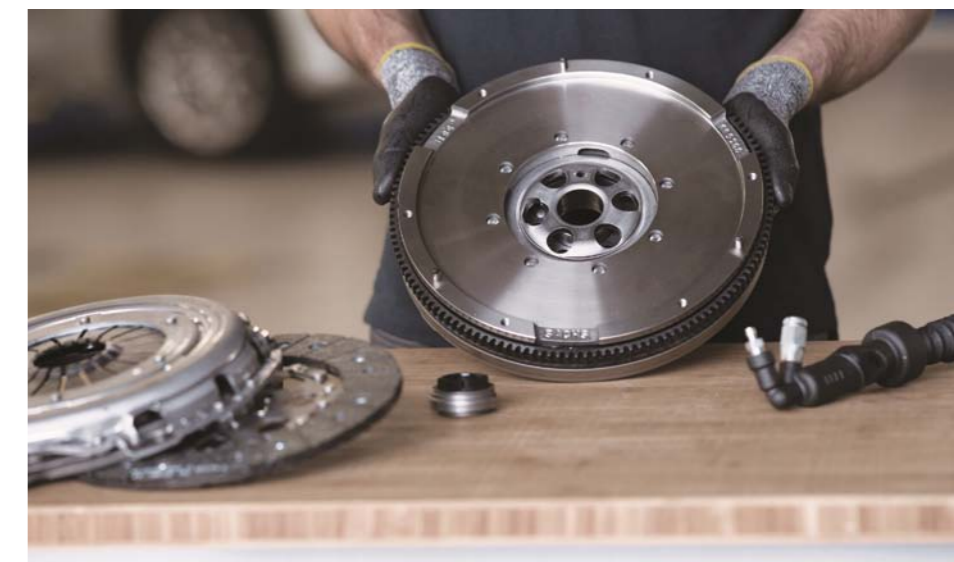
TARCZA SPRZĘGŁA POWINNA BYĆ DOKŁADNIE SPRAWDZONA PRZED MONTAŻEM
