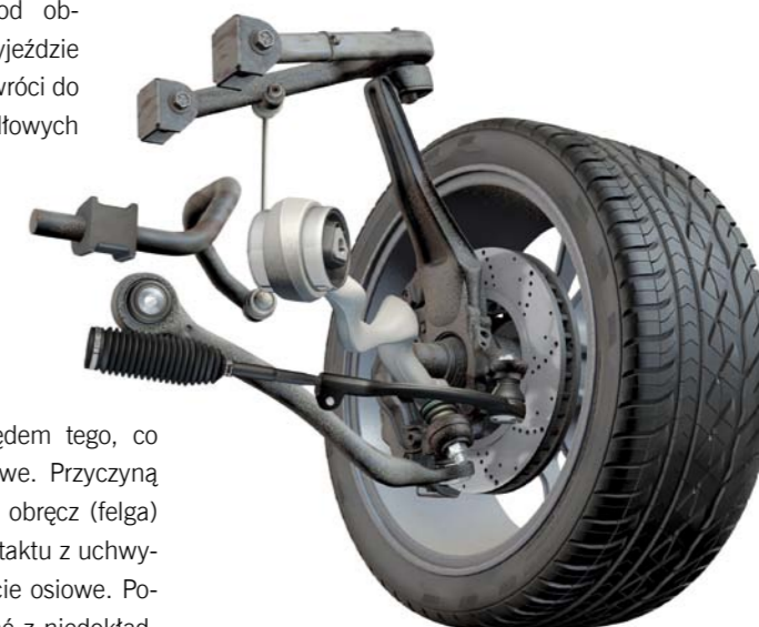
WZAJEMNE USYTUOWANIE PODSTAWOWYCH ELEMENTÓW ZAWIESZENIA POJAZDU
