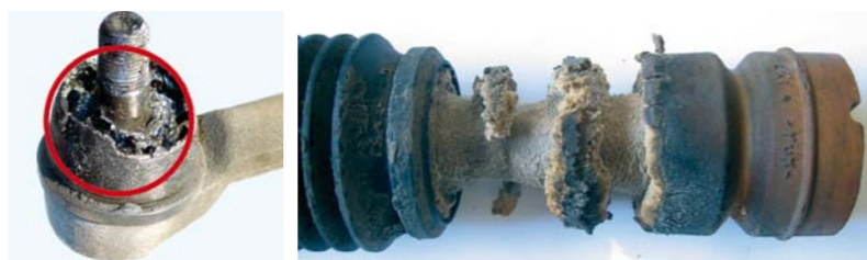
USZKODZENIA ELEMENTÓW PODWOZIA SPOWODOWANE KOROZJĄ
