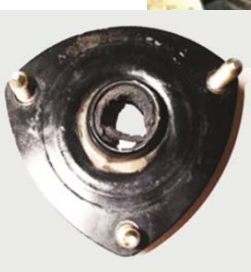
USZKODZONE MOCOWANIE GÓRNE
