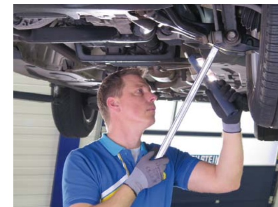
WYMIANA ELEMENTÓW ZAWIESZENIA PNEUMATYCZNEGO JEST STOSUNKOWO PROSTA
