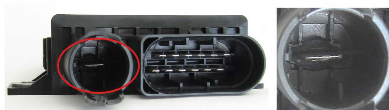
STEROWNIK PRACY ŚWIEC ŻAROWYCH NIE MUSI BYĆ PRZYCYNĄ NIESPRAWNOŚCI UKŁADU
