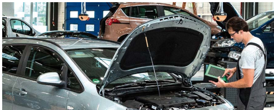
POŁĄCZENIE AUTA Z SYSTEMEM DIAGNOSTYCZNYM NASTĘPUJE ZA POŚREDNICTWEM ZŁĄCZA EOBD
