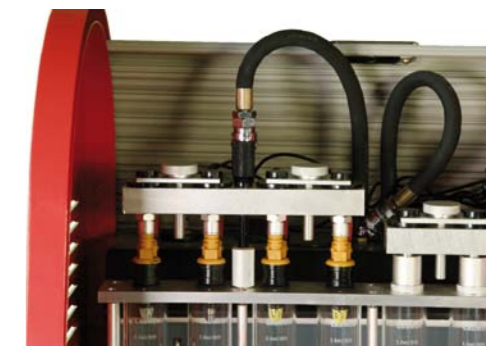
LISTWA DOPROWADZAJĄCA PALIWO DO TESTOWANYCH WTRYSKIWCZY
