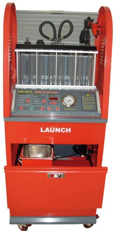
URZĄDZENIE CNC 801 UMOŻLIWIA JEDNOCZESNĄ OBSŁUGĘ OŚMIU WTRYSKIWCZY
