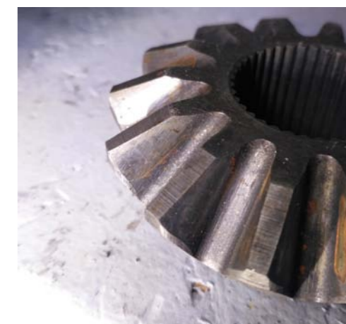
NACISKI WYSTĘPUJĄCE POMIĘDZY ZĘBAMI KÓŁ POWODUJĄ ŚCINANIE OLEJU OBNIŻAJĄCE JEGO LEPKOŚĆ
