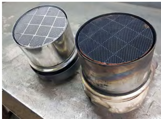
Z PRAWEJ: FILTR CAŁKOWICIE ZUŻYTY. Z LEWEJ: ZREGENEROWANY DO NATYCHMIASTOWEGO UŻYCIA
