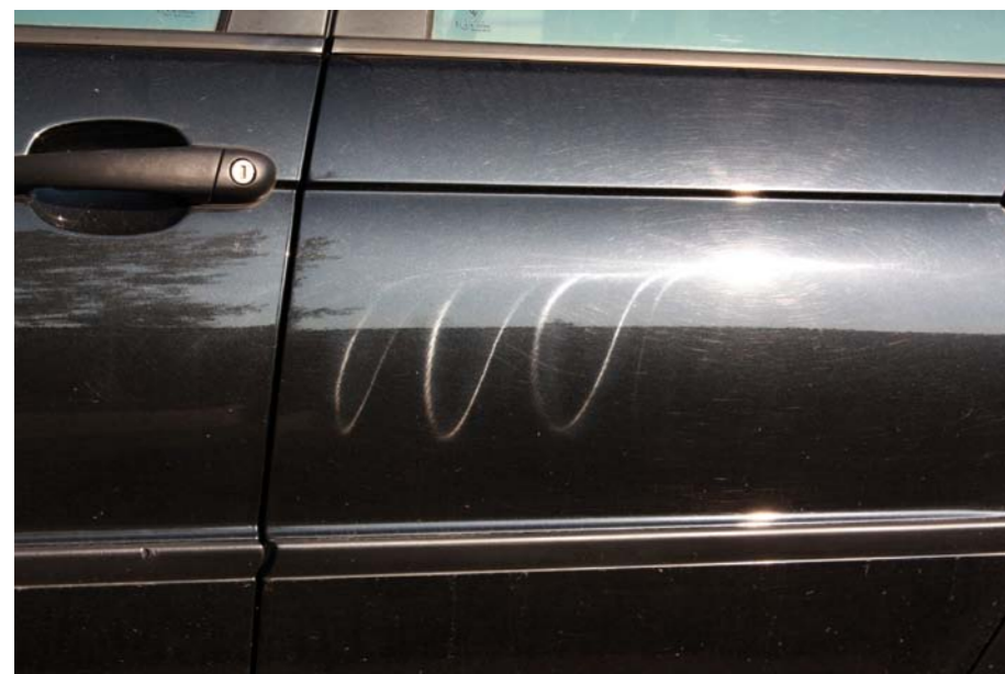
CZĘSTO SPOTYKANA WADA LAKIERNICZA NAZYWANA „EFEKTEM HOLOGRAMU”
