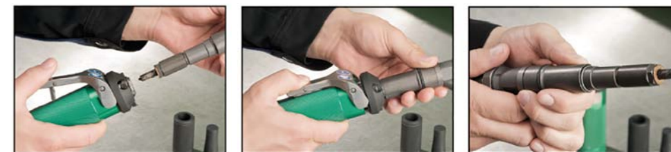
ZSUWANIE NOWEGO LUB POWTÓRNIENIE UŻYTEGO PIERŚCIEŃ Z TULEI DO ROWKA NA KORPUSIE WTRYSKIWACZA
