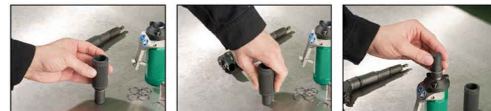
NASADZANIE NOWEGO PIERŚCIEŃ NA TULEI OCHRONNEJ PRZYRZĄDU
