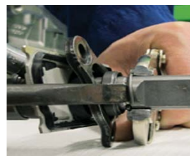
PRZYKŁAD NIEPRAWIDŁOWEGO (NIEBEZPIECZNEGO) DEMONTAŻU PIERŚCIEŃ SPRĘŻYSTEGO PRZY UŻYCIU KLESZCZY I WKRĘTAKA
