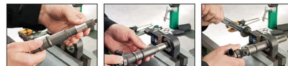
DEMONTAŻ PIERŚCIEŃ Z KORPUSU WTRYSKIWACZA Z WYKORZYSTANIEM METODY PRZECINANIA
