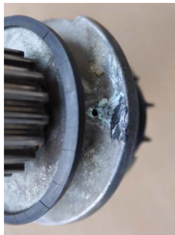
RYS. 5. ZAŚLEPIENIE OTWORU ODPOWIETRAJĄCEGO SILIKONEM
