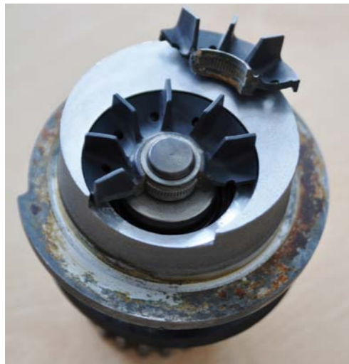
RYS. 4. USZKODZONY WIRNIK POMPY UKŁADU CHŁODZENIA
