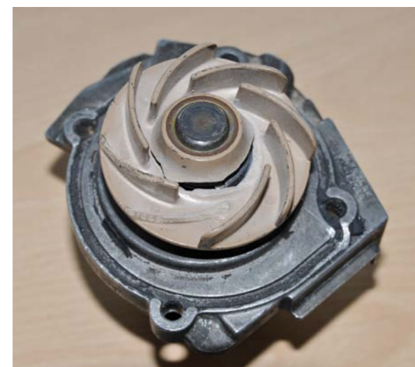
RYŚ. 1. USZKODZENIE WIRNIKA W WYNIKU NIEPRAWIDŁOWEGO MONTAŻU
