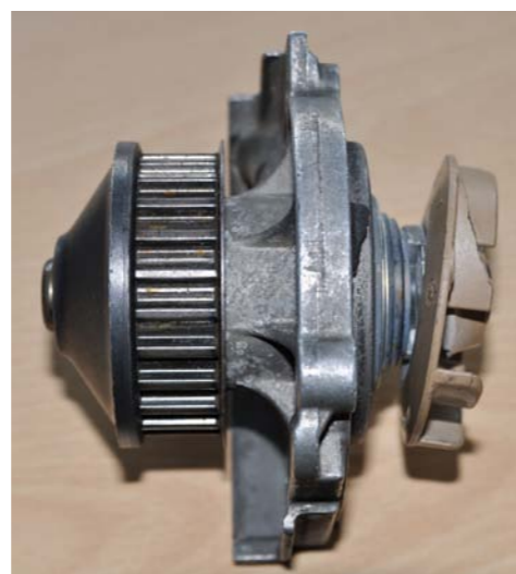
RYŚ. 2. OSTRA KRAWĘDZ WĘWĘTRZNA KOŁA POMPY
