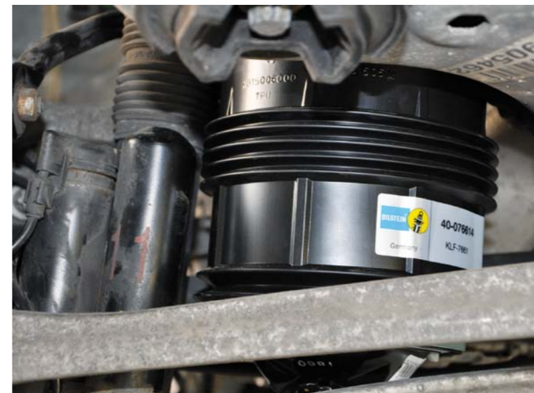
MIECH PNEUMATYCZNY ZAMONTOWANY W TYLNYM ZAWIESZENIU SAMOCHODU
