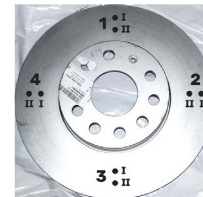
FOT. 2: PUNKTY POMIAROWE GRUBOŚCI TARCZ HAMULCOWYCH
