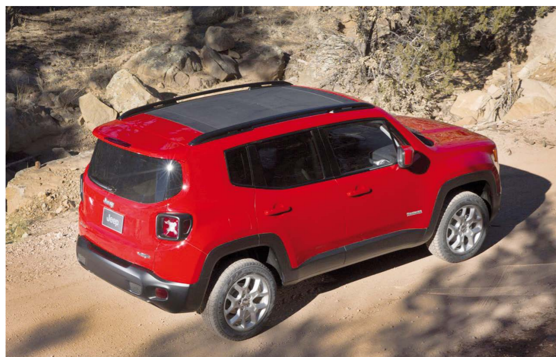
PLĄT DACHOWY Z NOWYCH MATERIAŁÓW ZMNIEJSZA MASĘ CAŁEGO POJAZDU
