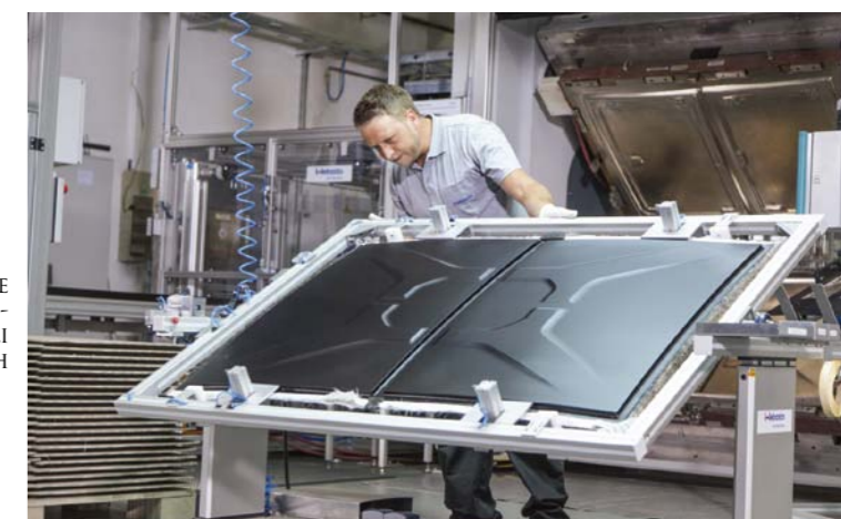
FORMOWANIE KOMPOZYTOWYCH PANELI DACHOWYCH
