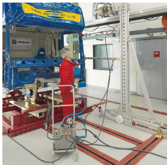
STANOWISKO DO NAPRAWY KABIN ZAMOCOWANE DO GŁÓWNEJ RAMY PODŁOGOWEJ
