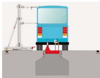
NAPRAWA ODKSZTAŁCONEGO NADWOZIA AUTOBUSU NA STANOWISKU KANAŁOWYM
