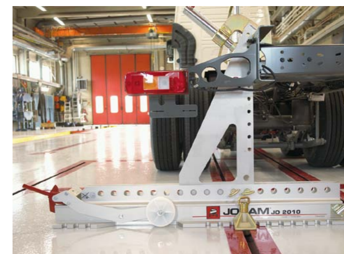
PROSTOWANIE RAMY ODKSZTAŁCONEJ W PŁASZCZYŹNIE POZIOMEJ
