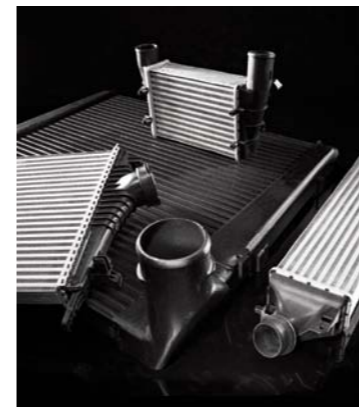
KONSTRUKCJA INTERCOOLERA UNIEMOŻLIWIA SKUTECZNE CZYSZCZENIE JEGO WNIĘTRZA
