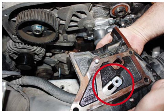
NAKRĘTKA MOCOWANIA NAPINACZA PASKA WYMAGAJĄCA KAŻDORAŻOWEJ WYMIANY
