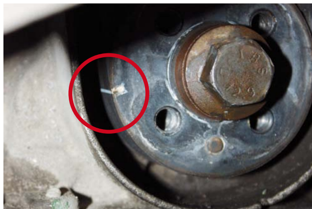
PRAWIDŁOWA POZYCJA NOWEGO PASKA NA KOLE PASOWYM WAŁU KORBOWEGO
