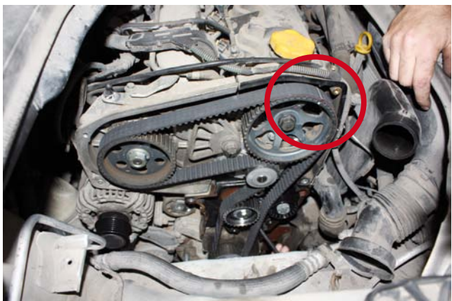
ZNANKI NOWEGO PASKA I KOŁA PASOWEGO WAŁU ROZRZĄDU MUSZĄ SIĘ POKRYWAĆ
