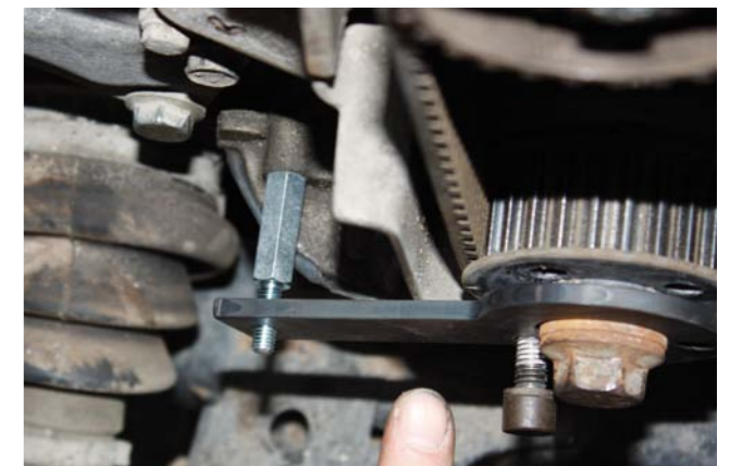
SPOSÓB ZAMONTOWANIA BLOKADY WAŁU KORBOWEGO NA JEGO KOLE PASOWYM
