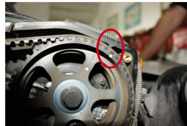
PRAWIDŁOWE USTAWIENIE WAŁU ROZRZĄDU WEDŁUG ZNAKU NA KOLE PASOWYM
