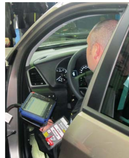
ZADANIE FIRMY FEBI WYMAGAŁO UŻYCIA TESTERA DLA ZNALEZIENIA USTERKI POWODUJĄCEJ UTRATĘ MOCY SILNIKA
