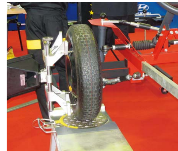
TRENINGOWY MODEL PRZEDNIEGO ZAWIESZENIA SAMOCHODU DOSTARCZONY PRZEZ FIRMĘ PRECYZJA TECHNIK SŁUŻYŁ DO ZADAŃ KONKURSOWYCH Z ZAKRESU KONTROLI GEOMETRII PODWOZI
