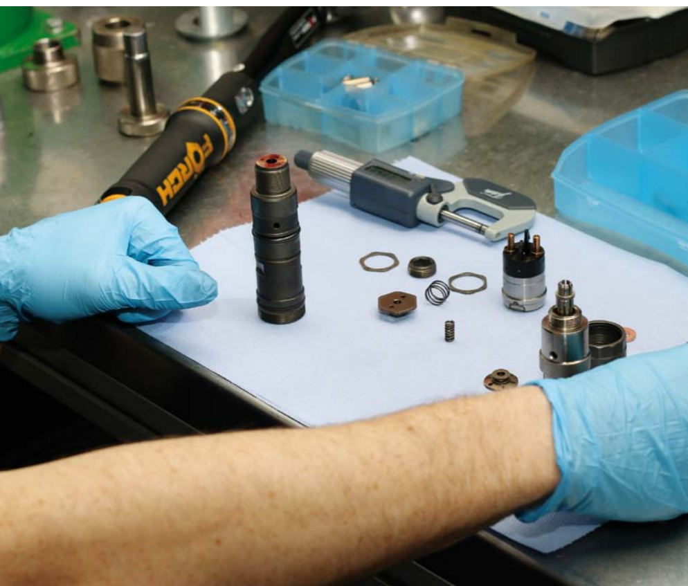
PPROCES REGENERACJI WTRYSKIWACZA COMMON RAIL PRZEBIEGA WIELOETAPOWO
