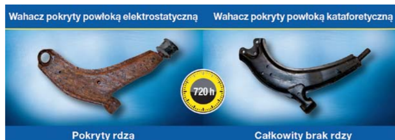
TEST ODPORNOŚCI WAHACZA NA KORYZJĘ; REZULTATY PO 720 GODZINACH W KOMORZE SOLNEJ, CO ODPOWIADA OKRESOWI OKOŁO 8-10 LAT EKSPLOATACJI W EUROPIE
