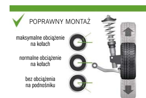
FOT. 11. ZACHOWANIE ZAMONTOWANEJ TULEI METALOWO-GUMOWEJ PRZY RÓŻNYCH OBCIĄŻENIACH ZAWIESZENIA
