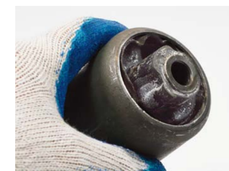
FOT. 8, 9, 10. USZKODZENIE CZĘŚCI GUMOWEJ PRZEZ NIEPRAWIDŁOWO WYWIERANY NACISK PODCZAS WPRASOWYWANIA
