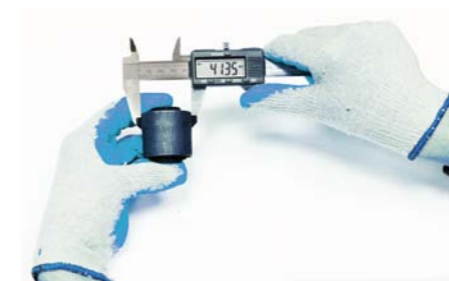
FOT. 6. POMIAR ŚREDNICY NOWEJ TULEI PRZEZNACZONEJ DO WPRASOWANIA
