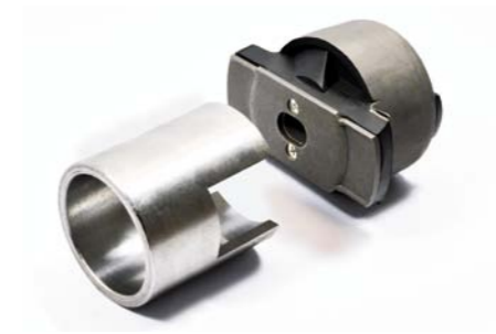
FOT. 7. NIETYPOWA TULEJA I PRZYRZĄD SŁUŻĄCY DO JEJ WCISKANIA
