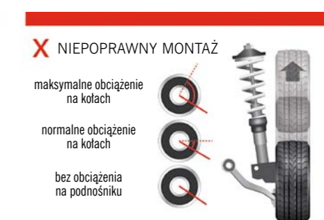
FOT. 11. ZACHOWANIE ZAMONTOWANEJ TULEI METALOWO-GUMOWEJ PRZY RÓŻNYCH OBCIĄŻENIACH ZAWIESZENIA
