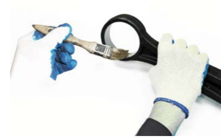
FOT. 5. SMAROWANIE GNIAZDA WAHACZA OLEJEM UŁATWIĄJĄCYM WYKONANIE POŁĄCZENIA WCISKOWEGO
