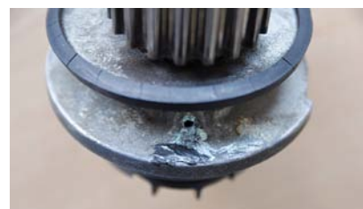
RYS. 8. ZAŚLEPIENIE OTWORU ODPOWIETRZAJĄCEGO SILIKONEM
