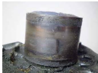
RYS. 4. ZATARTA POMPA WODY KRÓTKO PO WYMIANIE PASKA
