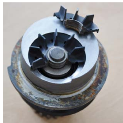
RYS. 7. USZKODZONY (PĘKNIĘTY) WIRNIK POMPY WODY
