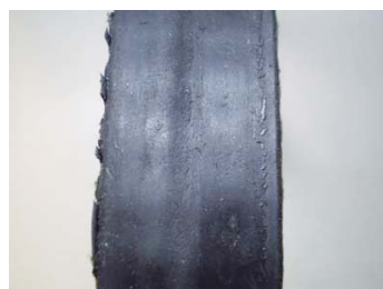
RYS. 5. SPALONY PASEK ROZRZĄDU. WSPÓŁPRACUJĄCY Z ZATARTĄ POMPĄ
