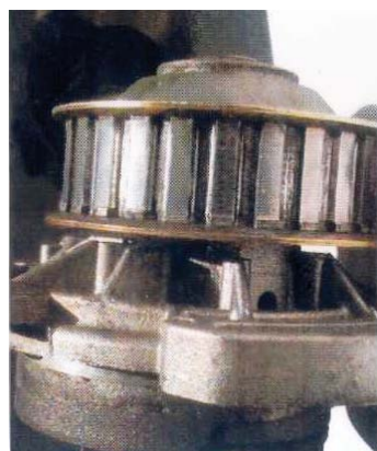
RYS. 6. NADMIERNIE ZUŻYTE KOŁO PASOWE (CHARAKTERYSTYCZNY ZARYS ZĘBÓW)
