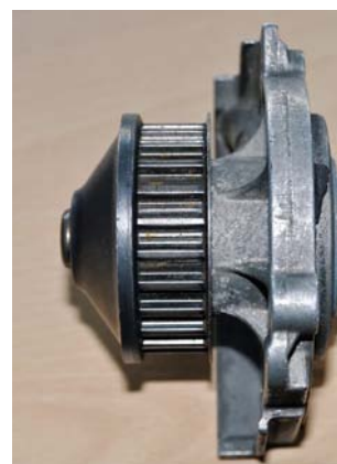
RYS. 2. OSTRA KRAWĘDź BIEŻNI KOŁA PASOWEGO
