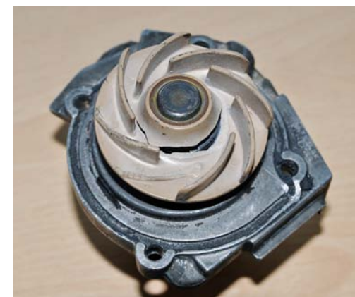
RYS. 1. USZKODZENIE WIRNIKA W WYNIKU NIEPRAWIDŁOWEGO MONTAŻU
