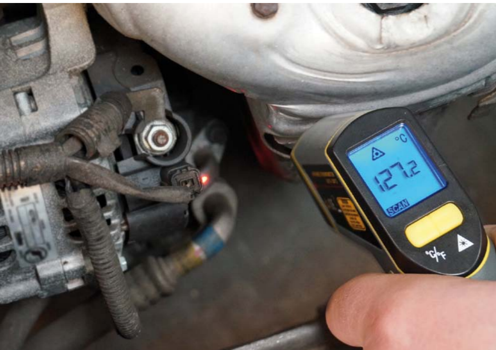
PROSTY TERMOMETR WYKORZYSTUJĄCY PODCZERWIĘŃ DOSTARCZA KLUCZOWYCH INFORMACJI NA TEMAT WYDAJNOŚCI I USTEREK UKŁADU KLIMATYZACJI
