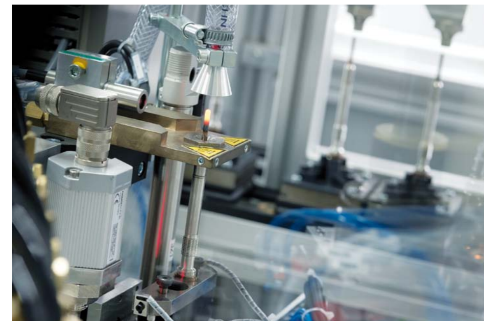
PODCAZ FABRYCZNEGO TESTU ŚWIECY ŻAROWEJ BERU Z CZUJNIKIEM CIŚNIENIA PSG SPRAWDZA SIĘ, CZY PRĘT GRZEJNY OSIĄGA WŁAŚCIWĄ TEMPERATURĘ W ODPOWIEDNIO KRÓTKIM CZASIE
