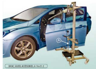
FOT. 9. WYKORZYSTANIE SMARTPULLERA DO WEWNĘTRZNEGO TRANSPORTU I PRECYZYJNEGO MONTAŻU DRZWI
