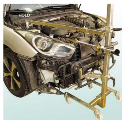
FOT. 2. SIŁA PROSTUJĄCA MOŻE BYĆ WYWIERANA ZA POMOCĄ CENTRALNEJ ŚRUBY I ZGRZEWANYCH ZACZEPÓW. REAKCJE PRZENOSZONE SĄ SYMETRYCZNIE Z GŁÓWNEJ BELKI PRZEZ GUMOWE OPORY NA SZTYWNE CZĘŚCI NADWOZIA
