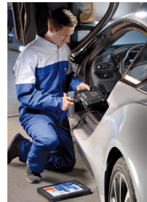
ZASTOSOWANIE URZĄDZENIA NAVIGATOR TXTS W DIAGNOZOWANIU SAMOCHODU OSOBOWEGO
