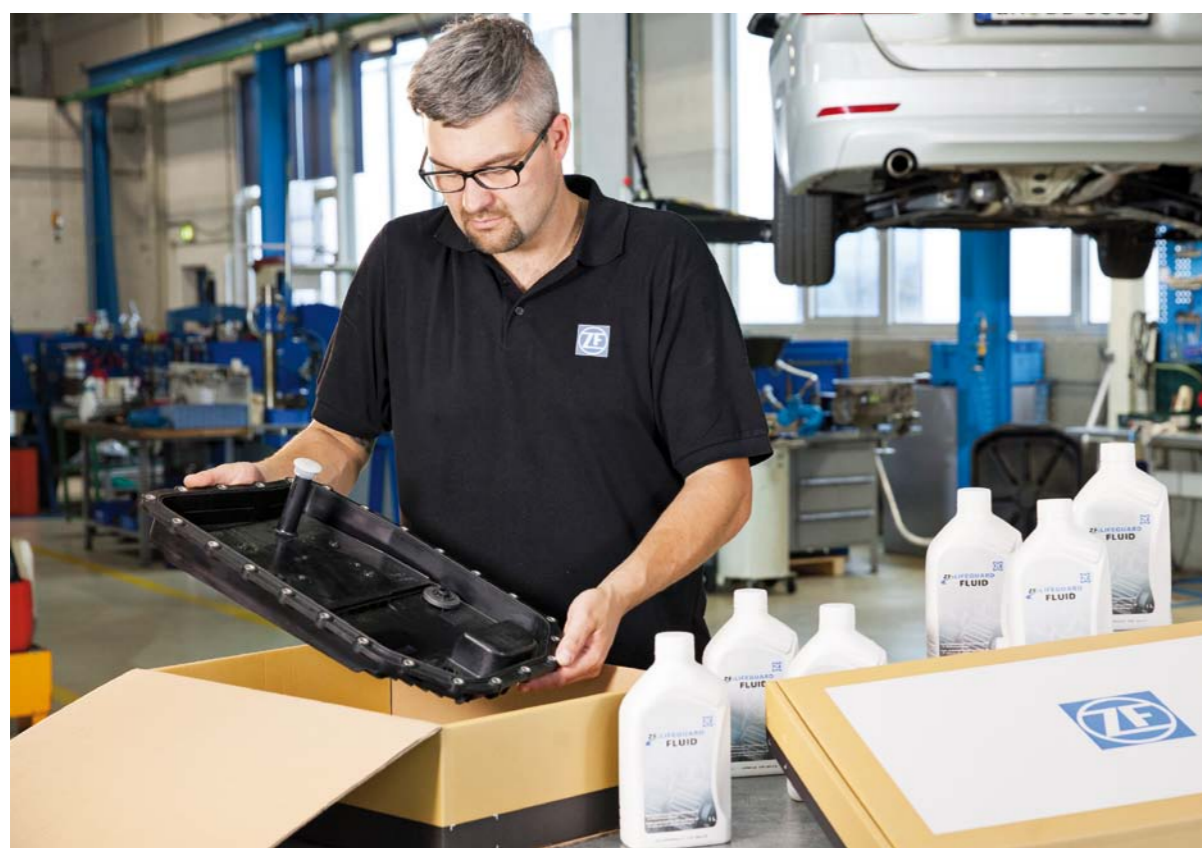
W SKŁAD ZESTAWU WCHODZI TEŻ MISKA OLEJOWA WYMAGAJĄCA WYMIANY PRZY KAŻDYM SERWISOWANIU SKRZYNI
