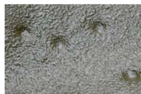
PRÓBKA COBRA PO BADANIU ODPORNOŚCI NA UDERZENIE WG DUPONTA
