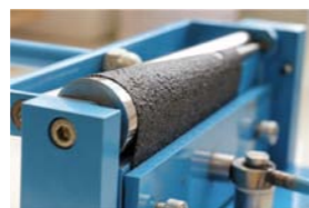
PRÓBKA COBRA PODCZAS BADANIA ZGINANIA NA SWORZNIU STOŻKOWYM
