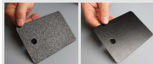
PRÓBKA COBRA PO BADANIU ODPORNOŚCI NA UDERZENIE WG DUPONTA
