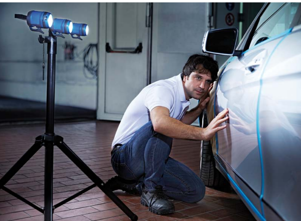
SPRAWDZANIE JEDNORODNOŚCI ODCIENIA LAKIERU ZESTAWEM MDLS CRI
