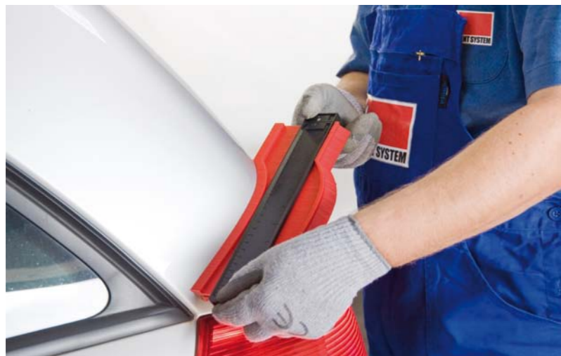
WARSZTATOWA WYMIANA ELEMENTÓW BLACHARSKICH POWODUJE ODKSZTAŁCENIA WTORNE. USUWANE NASTĘPNIE POD WZGLĘDEM WIZUALNYM PRZEZ SZLIFOWANIE I SZPACHLOWANIE
