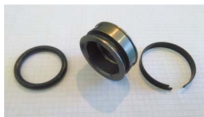
RYS. 10. SEPARATOR ODDZIELAJĄCY PRZESTRZEŃ OLEJOWĄ OD GAZOWEJ
