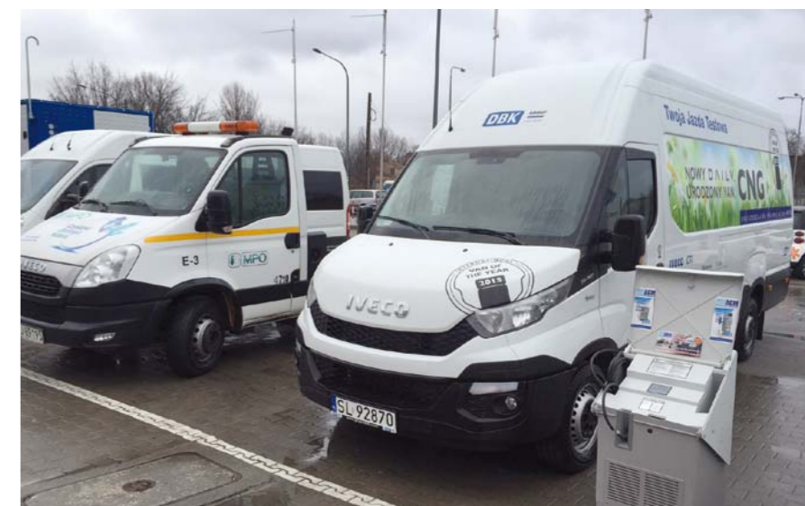
SAMOCHÓD DOSTAWCZY Z FABRYCZNĄ INSTALACJĄ CNG TANKOWANY Z KOMPRESORA SMALL QFMQ2.5
