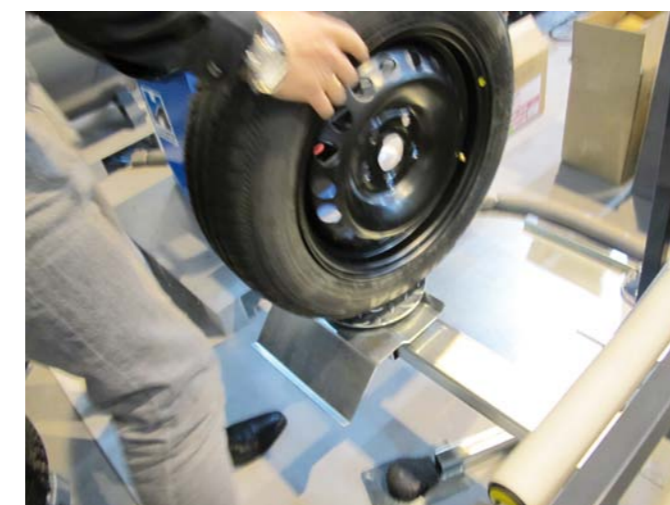
PÓŁAUTOMATYCZNY, STEROWANY PEDAŁEM DŹWIGNIK Z OBROTOWĄ ŁAPĄ UŁATWIA OSADZENIE KOŁA NA WRZECIONIE WYWAŻARKI (Z LEWEJ: WIDOK URZĄDZENIA, Z PRAWY: SPOSÓB JEGO UŻYCIA)
