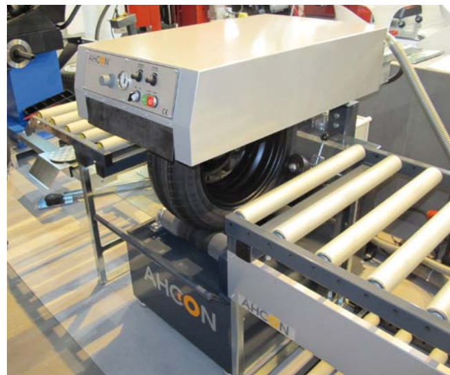
FUNKCJA ZWANA „MASAŻEM OPON” DOSTĘPNA W NOWOCZESNYCH WYWAŻARKACH JEST W LINII AHCON REALIZOWANA PRZEZ OSOBNÉ URZĄDZENIE
