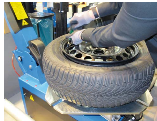
NA TEJ SAMEJ MONTAŻOWNICY ZAKŁADANE SĄ NOWE OPONY DOSTARCZONE NA UNIWERSALNYM OŚMIOBOCZNYM WÓZKU
