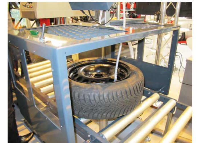
BEZPIECZNA I WYGODNA W UŻYCIU KLATKA OCHRONNA DO POMPOWANIA KÓŁ ŁĄCZY SIĘ Z POZOSTAŁYMI URZĄDZENIAMI ZA POMOCĄ MODUŁOWYCH STOŁÓW ROLKOWYCH
