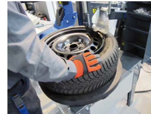
OSOBNY ZBIJAK LEMIESZOWY UPRASZCZA WSTĘPNĄ FAZĘ DEMONTAŻU OPON I PÓŹNIEJSZĄ OBSŁUGĘ MONTAŻOWNICY
